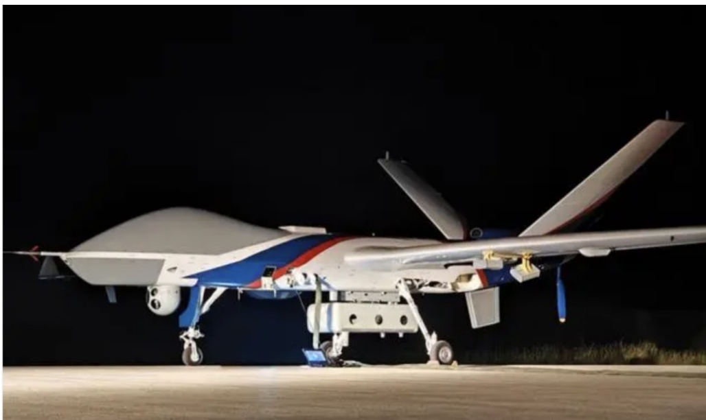
图一、翼龙-2型无人机搭载 光电设备和合成孔径雷达（SAR）
